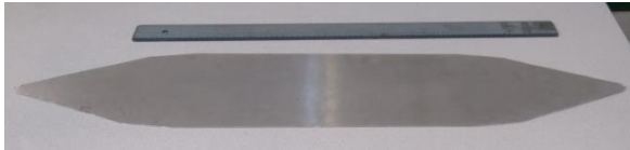
Fig. 5. Septum of the TEM cell.
